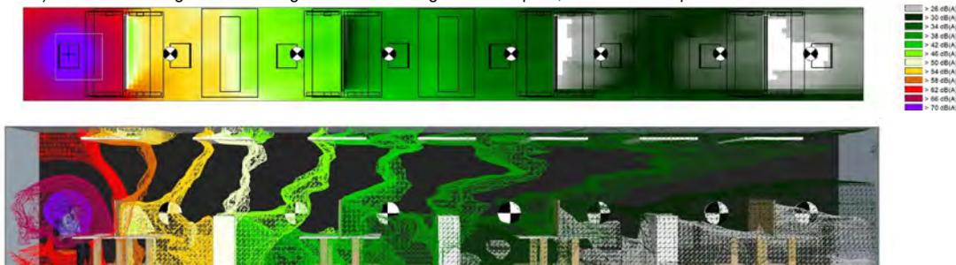
Bild 7. Ausbreitungsvariante im 3D-Modell im Zusammenspiel von Deckenabsorbern und Schirmen mit einer Höhe von 80 cm über Tischoberkante (Aufsicht und Schnitt).
