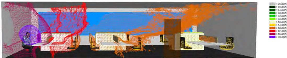
b) 35 cm Schirmung (Ok Schirmung 110 cm) mit Wand- und Deckenabsorbern (Nachhallzeit entspricht ASR A3.7)
